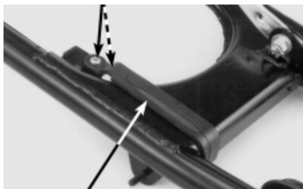
DESLIZADOR DA CORRENTE DE TRANSMISSÃO
