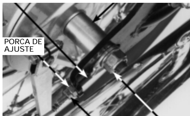
CONTRAPORCA EIXO/PORCA ESPELHO DE FREIO
