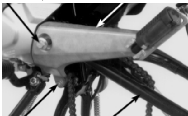
PARAFUSO LIMITADOR DO BRAÇO
